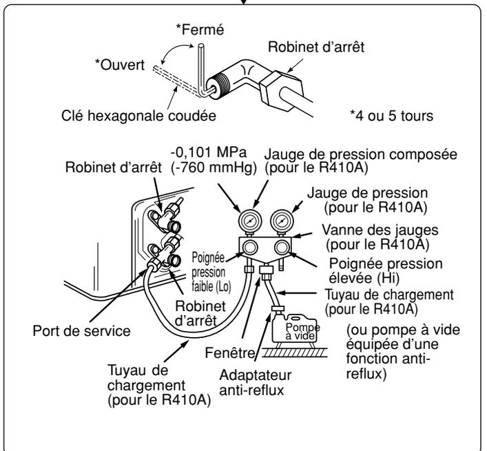
Enlever rapidement la soupape multiple de manomètre de la sortie de service de la soupape d'arrêt.
